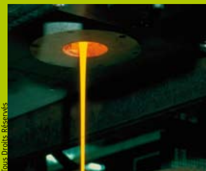
Coulée de verre dans un atelier de vitrification de déchets radioactifs.
